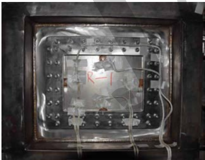
图 31 应变片位置以及试验件安装位置 Fig. 31 Strain gauge location and installation location of test piece
